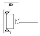
Versione con kit fissaggio nel legno o cartongesso
